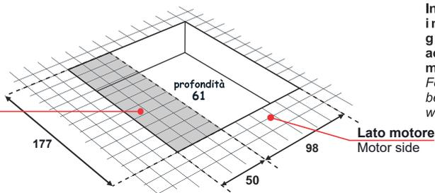
In caso di installazione ad incasso è necessario garantire una corretta aerazione con due griglie min. Ø15cm.
